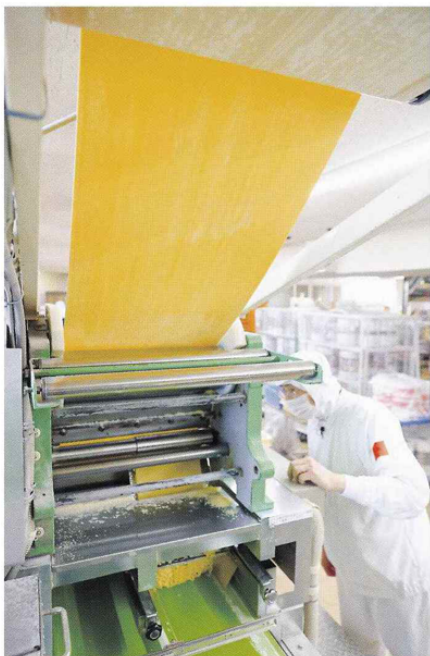
西山製麺の麺の製造工程。長い帯状のラーメン生地が機械を通して切り出され、ちぢれ麺となる
