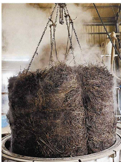
蒸留後、蒸留釜から取り出されたハッカの葉や茎 = 9月（滝上町提供）
