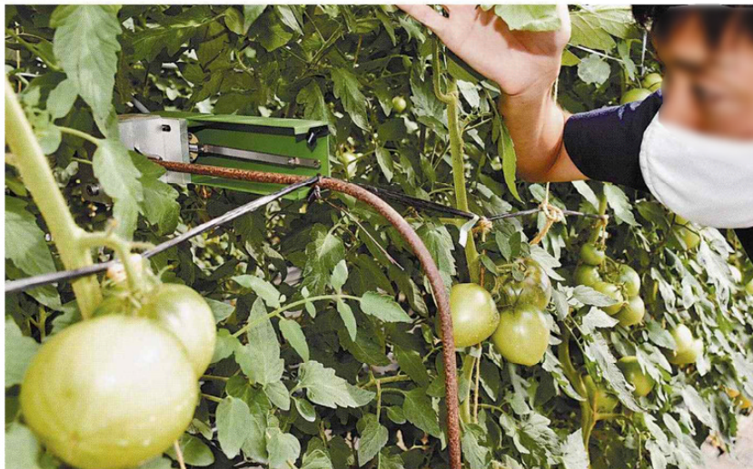
美瑛町のトマトハウスに設置した振動発生装置。緑色のカバーに囲われた特殊な金属棒が振動する
