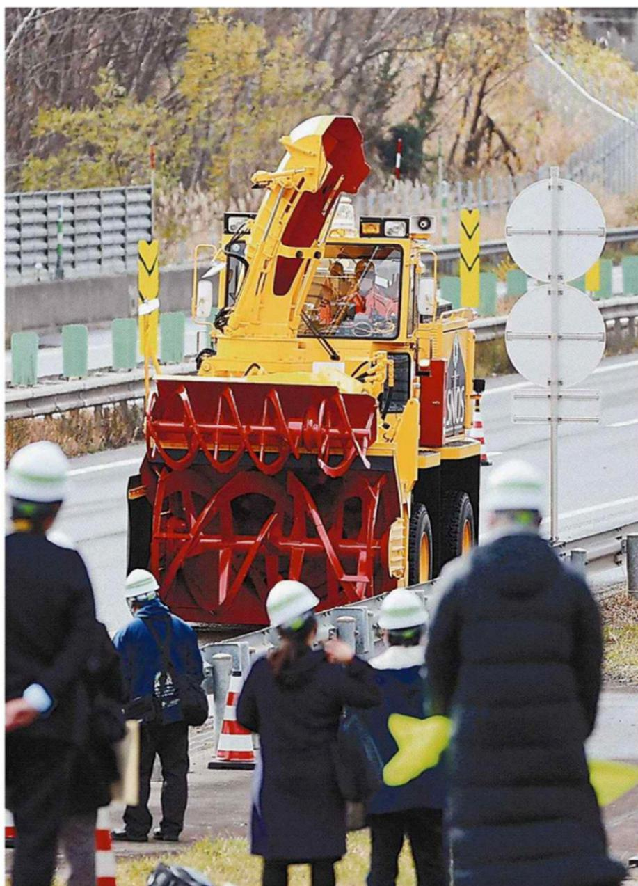
【岩見沢】東日本高速道路（ネクスコ東日本）北海道支社は17日、道央道岩見沢インターチェンジ（IC）付近で、自社で進めるロータリー除雪車の自動化の開発状況を報道陣に公開した。今冬は岩見沢IC―三笠IC間で実際に除雪しながら試験を重ねる方針で、2023年度の実用化を目指す。
